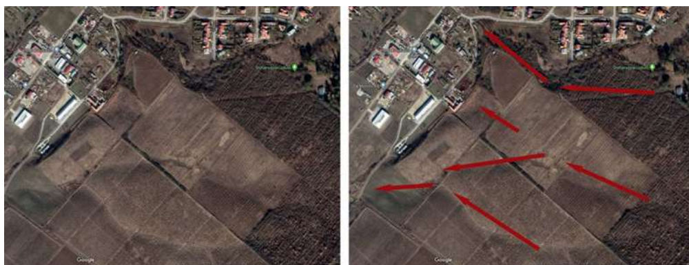
20. ábra Májer utca térségének csapadékvíz okozta problémák
